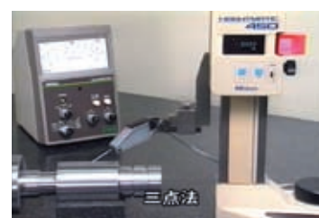
ダイヤルゲージや電気マイクロメータとVブロックなどによる三点法
